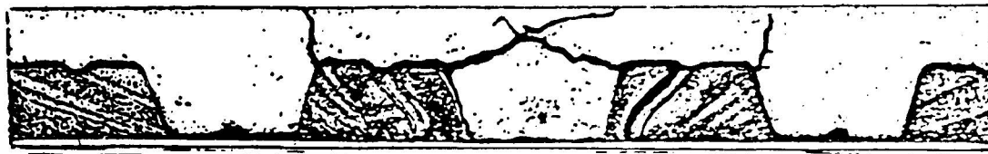
Fig. 5.4. Longitudinal rib shear failure.
