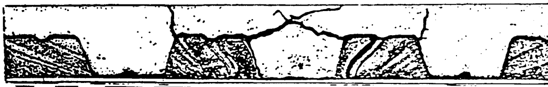
Fig. 5.4. Longitudinal rib shear failure.
